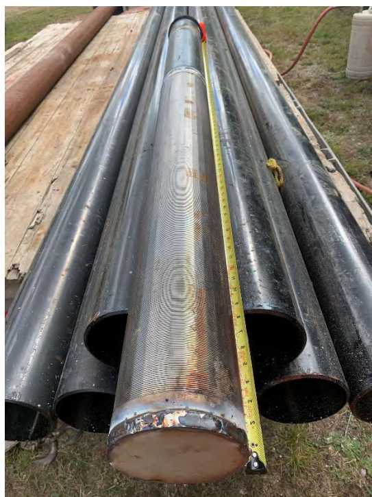
Photo 11 : Crépine installée au puits P-4
