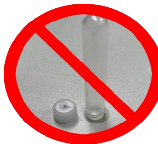
Tube et bouchon mal placés
